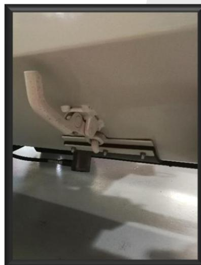
Une fois vos tuyaux et lance raccordés à la machine, ouvrez la vanne d'air qui est raccordé à votre lance. Ceci permettra la commande du régime moteur lors de la projection. Régler le diviseur sur le ratio de puissance transmise voulu. Ce ratio est affiner lors de la projection si vous souhaitez plus de puissance de projection ou à l'inverse moins.
